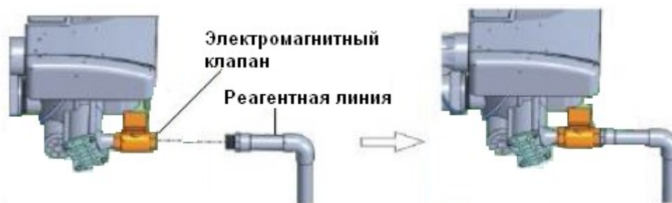
Рисунок 4 — Подключение реагентной линии в установке WS-34,0-Rx-(BS)
